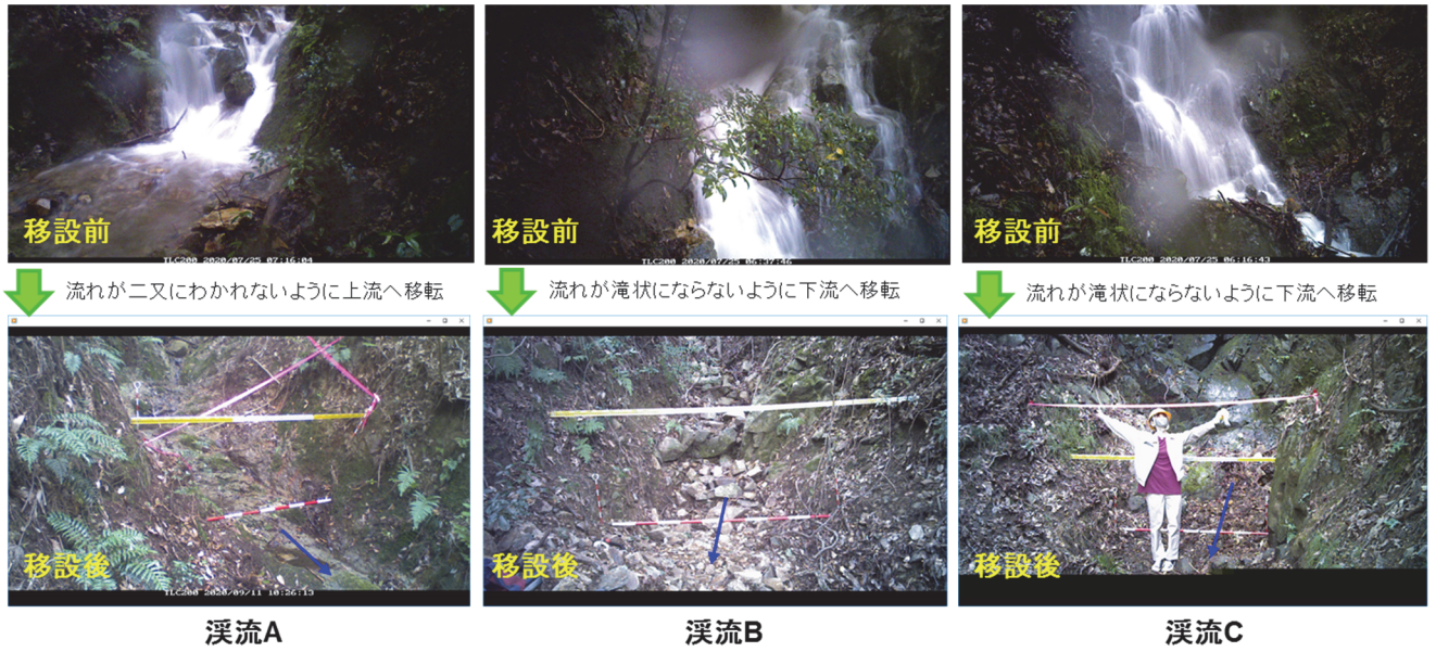
図-4.3.7 カメラ位置の変更と目印（リボンテープ）の設置状況
