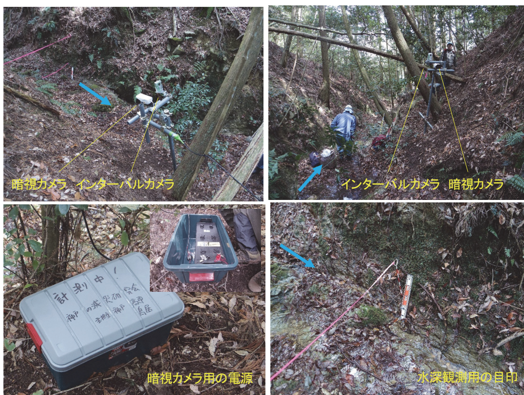
図-4.3.11 暗視カメラ設置及びインターバルカメラ観測再開状況【溪流A】(2021.3.17)
