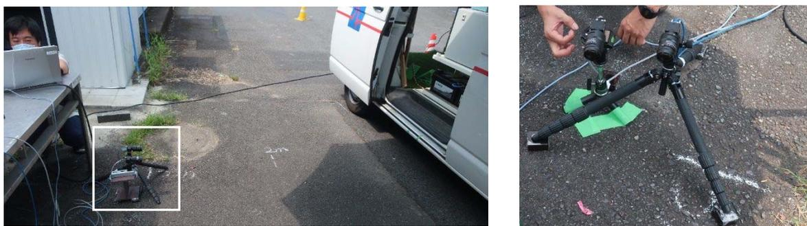
写真-4.2.2 高速動画カメラによる計測状況
