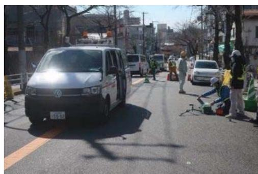
写真-4.1.1 OCMによるたわみ計測状況
