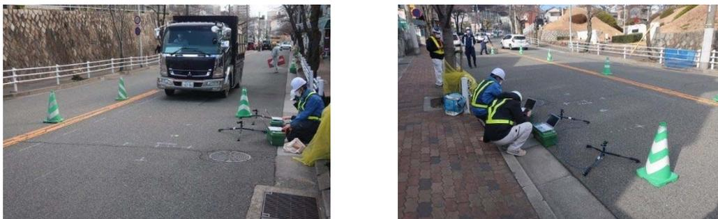
写真-4.4.1 車両荷重による路面変位計測状況
